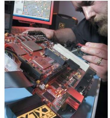
“ARM 社(世界有数の半導体IPプロバイダ)ではXJTAG バウンダリスキャン開発システムをデバッグ、テストを効率化するために採用し、RealView 開発ツールの多層・高密度実装ターゲットボードの開発工数と費用を削減しました”
