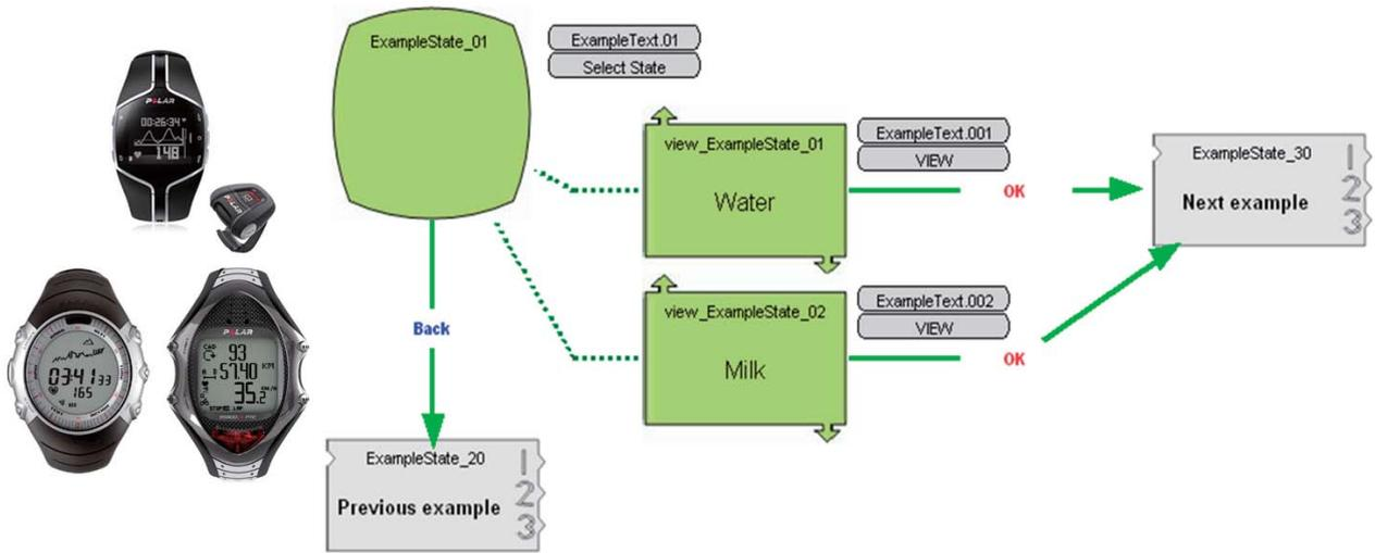
ドメインスペシフィックモデリング(Domain-Specific Modeling, DSM)は、ドメイン固有の概念を用いることで、コード実装に比較して開発の抽象レベルを引き上げます。そして高い抽象レベルでモデル化された仕様をコードやドキュメントに自動変換して、開発効率や品質を飛躍的に改善します。例えばPoral社のDSM(上図)は、スポーツウォッチの概念でわかりやすいモデルから、ジェネレータで完全なコードを自動生成して、開発の生産性を10倍以上改善しました。生成されるコードはマニュアル実装より高品質であることや、モデルが全ての利害関係者に理解されること、新しい開発メンバーが即戦力になることも成果として報告されています。
