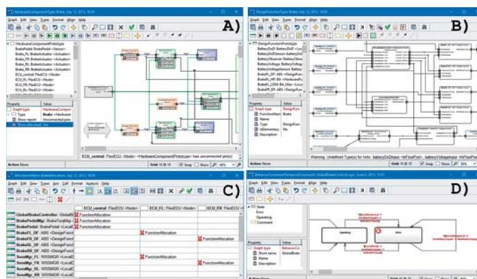
A) HW担当者2名が同じモデル図上の異なるHW部品を編集。同時にB)でシステムの論理コンポーネントをアーキテクトが定義。C)ではコード生成のために、A)とB)で編集されているHWと論理アーキテクチャ間の割当てを定義。D)では機能安全担当がB)で定義される論理コンポーネントのエラーモデルを定義。
